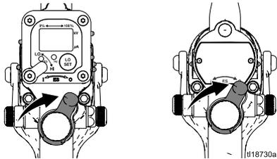
3. 关闭喷枪的供气 and 供料。按照 [泄压步骤, page 31](#) 进行操作。流体软管内不得有任何流体。
