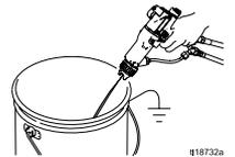
7. 打开隔离壳体门。将冲洗流体留在系统中，直到准备再次进行喷涂。
