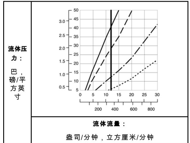
Table 5 . 孔径 1.0 毫米 ( 0.040 英寸 )
