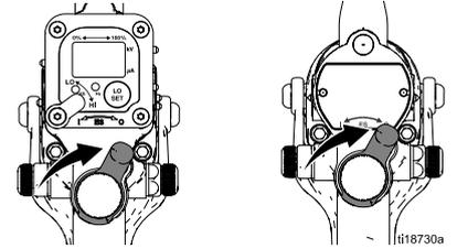
2. 完全拧掉壳体门 T 形手柄锁止螺丝。这可以关断通往喷枪的空气，并扳动接地柱体，释放残余电荷。
