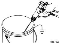
5. 按照流体供应装置手册中的指示，释放流体供应装置中的流体压力。
