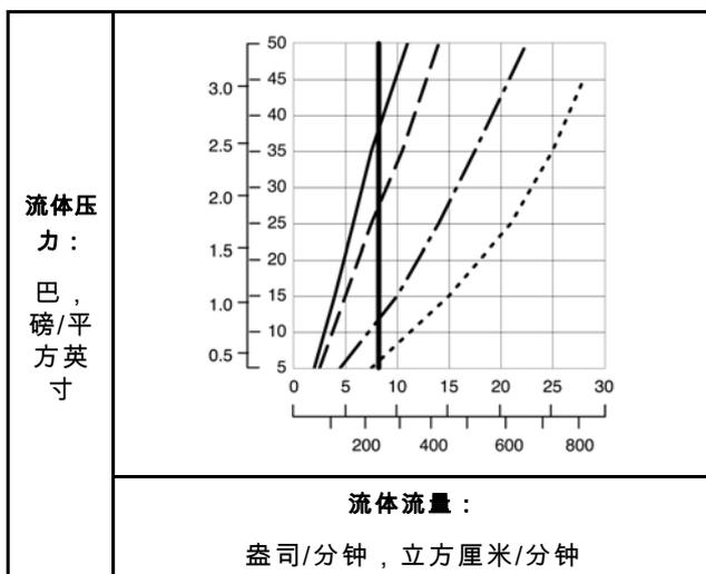
Table 9 . 孔径 2.0 毫米 ( 0.080 英寸 )
