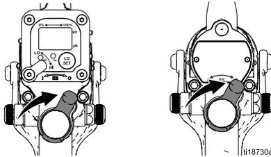
2. 释放系统电压。参见 [流体放电和接地步骤, page 30](#)。
