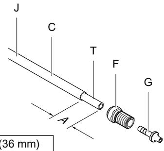
Figure 13 非铠装软管 24M733 在喷枪处的尺寸。
