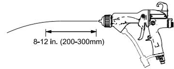
10. 设置喷枪空气调节器，以在扣动扳机时喷枪处至少有 45 磅/平方英寸 (0.32 兆帕，3.2 巴) 的压力，确保喷涂时为满电压。请参见下表。
