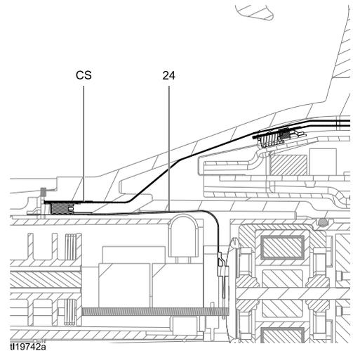
Figure 43 连接柔性电路
