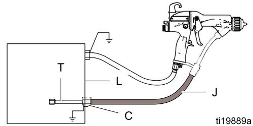
Figure 18 铠装流体软管和非 Graco 隔离壳体的连接
