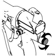
7. 逆时针将雾化空气限流阀 (G) 完全打开。
