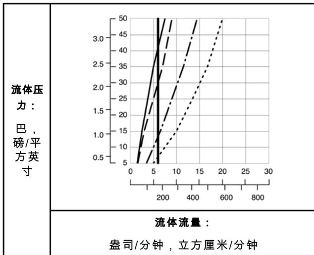
Table 8 . 孔径 1.8 毫米 ( 0.070 英寸 )
