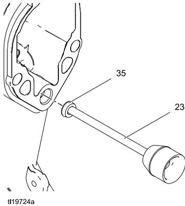
Figure 51 安装 U 形杯
