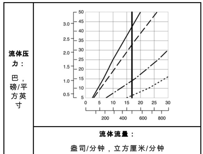
Table 6 . 孔径 1.2 毫米 ( 0.047 英寸 )
