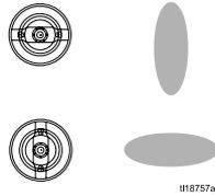
5. 逆时针将扇形空气调节阀 (F) 完全打开。
