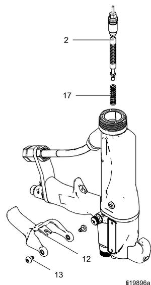
Figure 39 流体密封杆拆卸
